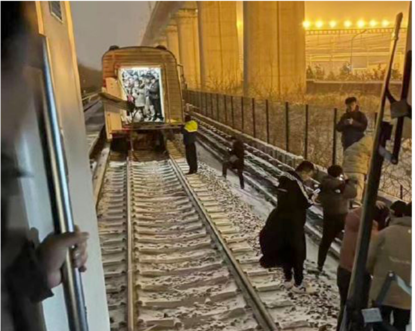
2023年12月14日，北京地铁昌平线一列车发生脱节事故。图：网上图片
