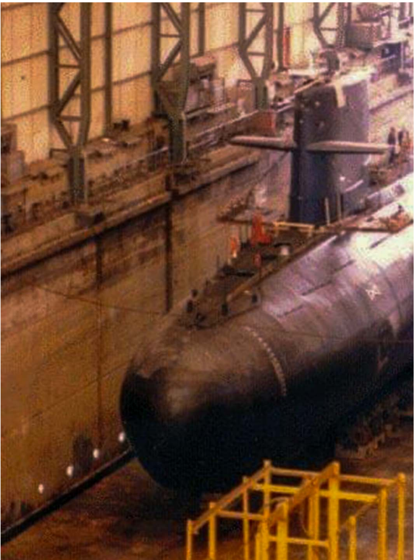
劍龍級潛艦在荷蘭建造時一景，舷側的排水縫孔清晰可見，與「海鯤號」完全相同。圖：網上圖片
